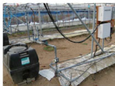
リーフソーラーかん水装置と点滴かん水システム
