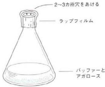
②三角フラスコが手で触れるくらい冷えたら(50°Cくらい)、下図のようにトレイにゲルを流し込む。コームはゲルを入れてからセットする。気泡が入った場合は、イエローチップで取り除く。
