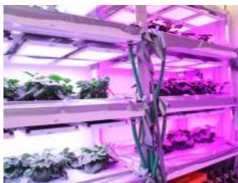
植物工場支援・研究施設：LED 照明付き養液栽培装置
