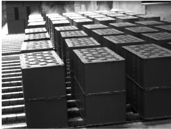
写真2：圧縮され固められたレンガ（同上）
