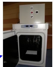
太陽光追尾装置を使った培養したヒト皮膚細胞への曝露実験 (昭和基地に設置)
